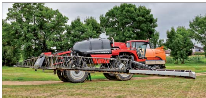
Nový samochoďný postrekovač Horsch Leeb s pracovným záberom ramien 36 metrov. Na stroji dokáže obsluha nastaviť svetlú výšku až do 2,1 metra a taktiež rozchod kolies.
